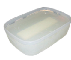
試験検体 シーネをゼラチンで中央に固定
