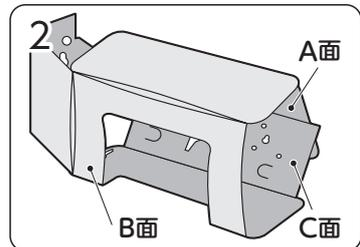
C面とA面を重ね合わせます。(A面が外側、C面が内側)
