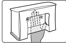
ホルダーと壁の隙間に手を入れ、手のひら全体でホルダーを手前に引っ張って外してください。
