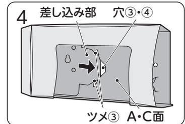
手順1で折り曲げた「ツメ③」を押さえながら「差し込み部」を、A・C面の手前から「穴③・④」に差し込みます。
