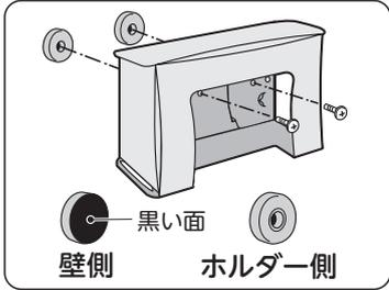
正面内側からネジを通し、背面からマグネットをドライバーで回し締めてください。
