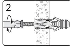
ネジをアンカーに途中まで差し込んだ後、PPEホルダーを挟んで一緒に締め付けてください。(インパクトドライバーを使用する際は、低速で確認しながら取り付けてください。)
