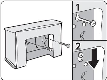
壁にネジを仮留めし、水平な位置を確認した後、本体を下にずらしてネジを増し締めします。
