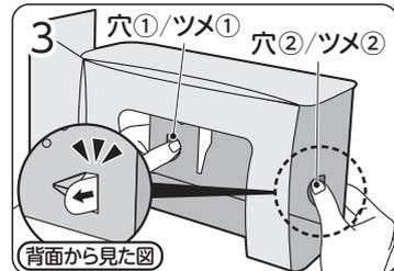
「穴①」と「ツメ①」を重ねて、「ツメ①」を指で奥まで押し込みます。「ツメ①」が背面から飛び出すまで押しください。同様に「穴②」と「ツメ②」も押し込みます。
