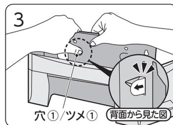
「穴①」と「ツメ①」を重ねて、「ツメ①」を指で奥まで押し込みます。「ツメ①」が背面から飛び出すまで押ししてください。
