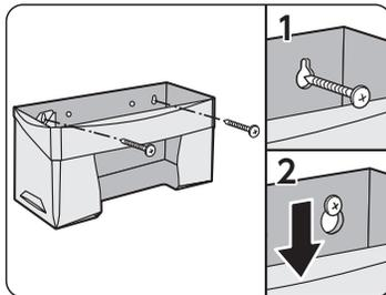
壁にネジを仮留めし、水平な位置を確認した後、本体を下にずらしてネジを増し締めします。
