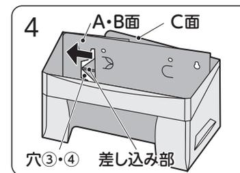
C面をA・B面に重ねて、手順1で折り曲げた「ツメ③」を押さえながら「差し込み部」を、A・B面の外側から「穴③・④」に差し込みます。
