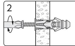
ネジをアンカーに途中まで差し込んだ後、PPEホルダーを挟んで一緒に締め付けてください。(インパクトドライバーを使用する際は、低速で確認しながら取り付けてください。)
