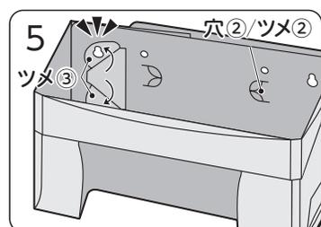
手前から「差し込み部」を引っ張り、「ツメ③」が飛び出すように広げます。手順3同様に「ツメ②」を「穴②」に押し込みます。
