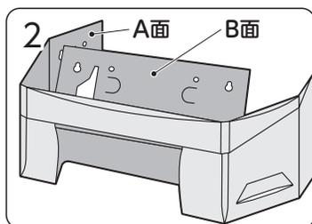
A面とB面を重ね合わせます。(A面が外側、B面が内側)
