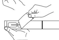
薬液ポケットの押さえ方や使用環境(低温下など)によっては、力が加わりすぎてフィルムが破れるなどの原因となり、薬液が漏れ出すことがあります。
